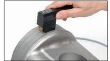
Misura della profondità della fessura di una cricca inclinata dopo la determinazione dell'angolo
