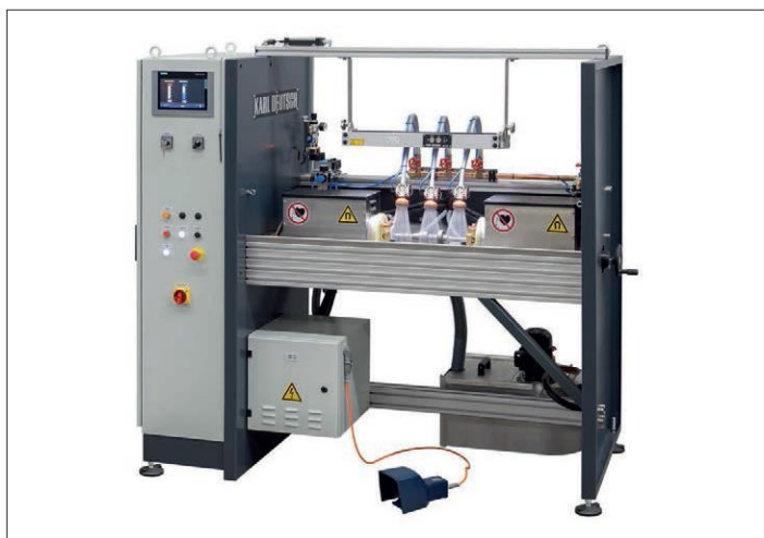
UWE 350: L'immagine mostra un'unità dotata di Memory II e doccette a spruzzo (opzione).
