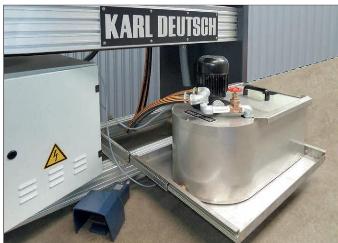
UWE 600 con contenitore estraibile per facilitare la pulizia ed il riempimento degli del prodotto
