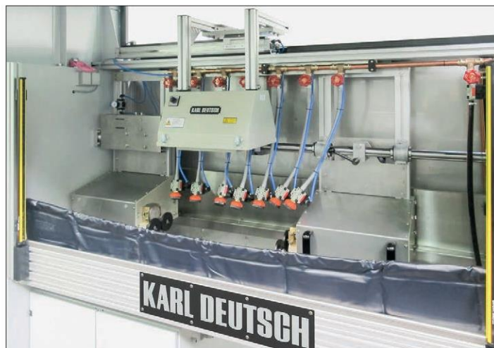
UWE 900 con portalamпада mobile pneumaticamente per un facile caricamento dall'alto dei componenti (disponibile anche con fotocellula)
