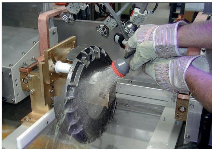
UWE 900 con barra magnetizzante per prove su componenti anulari. L'immagine mostra l'irrorazione con doccetta, entrambi i lati con corsa di serraggio.
