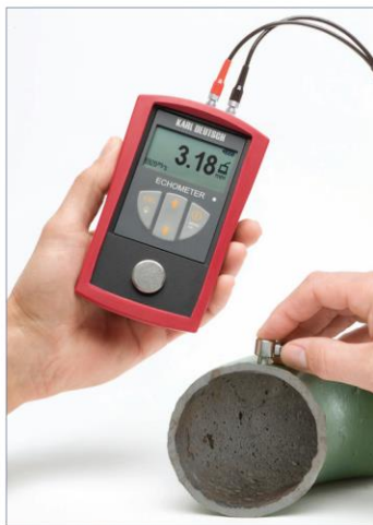
Misura di spessore su un tubo con sonda miniaturizzata
