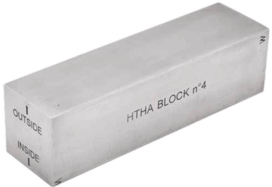
I blocchi vengono prima controllati per verificare l'assenza di indicazioni significative secondo la nostra procedura interna. Viene quindi eseguito un fenomeno accelerato di micro-cracking HTHA nello spessore del materiale mediante iniezione di una combinazione di idrogeno e carbonio per ottenere molecole di CH<sub>4</sub>.
